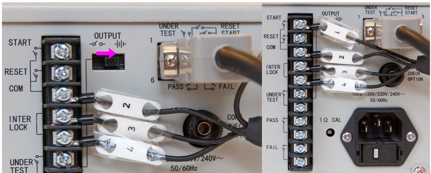
**ACHTUNG:** Entfernen Sie das Brückenkabel zwischen den Interlock-Pins, sofern vorhanden!
